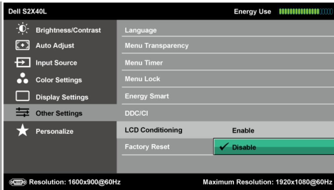
Jika gambar seperti tertinggal di monitor, pilih **Peremajaan LCD** untuk membantu menghilangkan retensi gambar. Penggunaan fitur Pengkondisian LCD dapat memerlukan waktu yang lama. Fitur Peremajaan LCD tidak dapat menghilangkan kasus parah retensi gambar atau efek terbakar.
