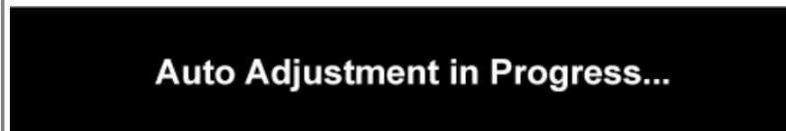
Penyesuaian Otomatis memungkinkan monitor menyesuaikan ke sinyal video masuk dengan sendirinya. Setelah menggunakan Penyesuaian Otomatis, Anda dapat lebih lanjut mengatur monitor dengan menggunakan kontrol Clock Piksel (Kasar) dan Fase (Halus) dalam Pengaturan Gambar.
